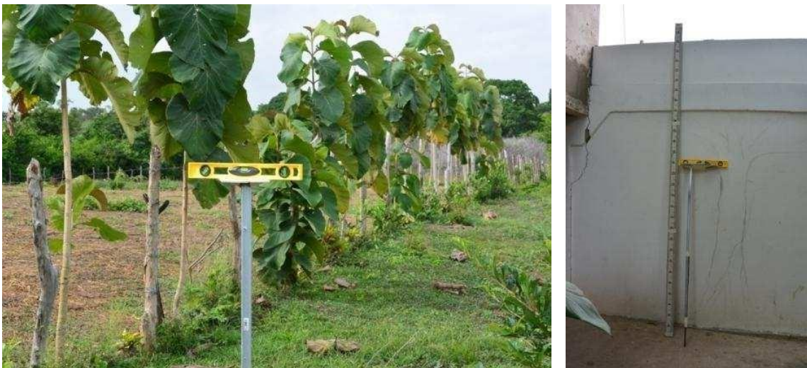
Abbildung 62: Nivellierausrüstung – provisorisch nachgebaut (Knopper 2018)
