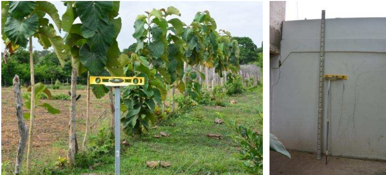
Abbildung 62: Nivellierausrüstung – provisorisch nachgebaut (Knopper 2018)
